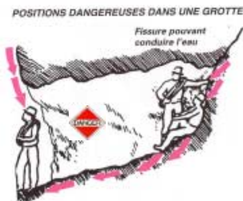
Figure 2 : Dangers de foudroiement indirect dans une grotte : l'alpiniste de gauche risque un amorçage sur sa tête, l'alpiniste de droite risque une tension de pas
